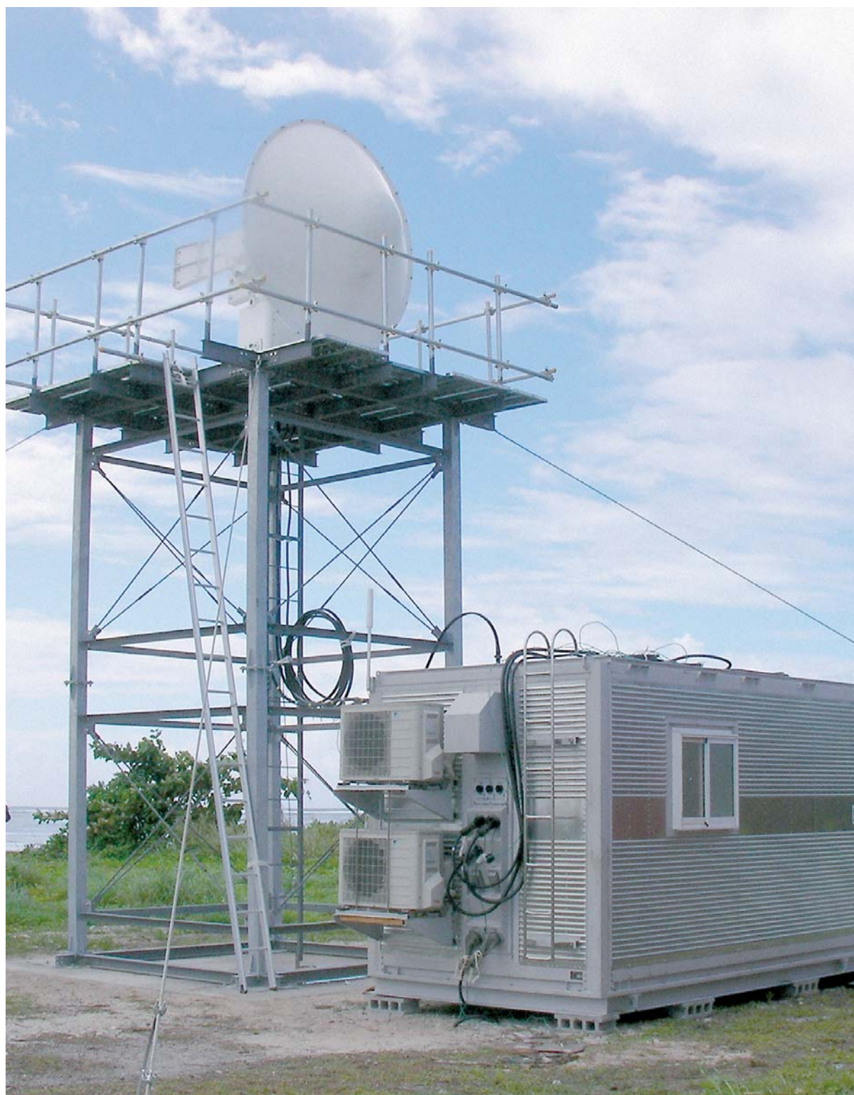
Slika 1.8. Radar na slici emitira posebni mikrovalni signal i prima signale odbijene od kapljica kiše. Na taj se način može odrediti količina kišnih kapi i njihovo gibanje.
