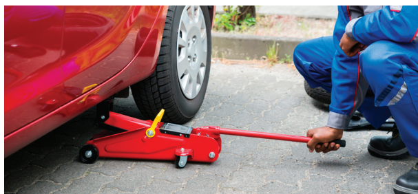
Slika 1.9. Podizanje automobila hidrauličkom dizalicom
