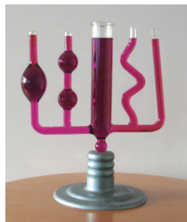
Slika 1.5. Hidrostatski tlak u spojenim posudama ovisi samo o visini stupca tekućine.
