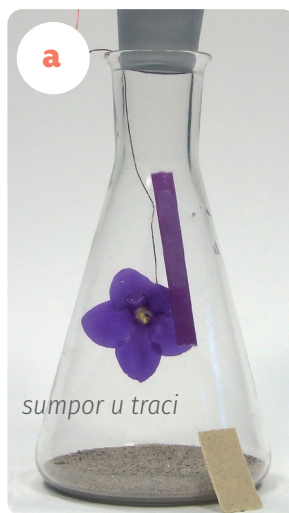
► Jednostavna aparatura za dobivanje sumporova(IV) oksida gorenjem sumpora i ispitivanje njegovih svojstava: (a) prije reakcije i (b) nakon reakcije
