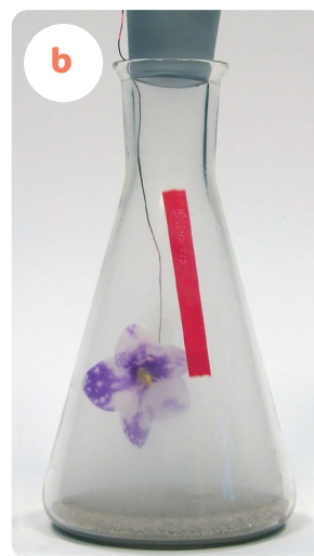
► Jednostavna aparatura za dobivanje sumporova(IV) oksida gorenjem sumpora i ispitivanje njegovih svojstava: (a) prije reakcije i (b) nakon reakcije
